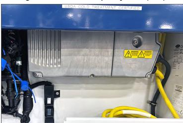
Figure 7.9 Variable Frequency Drive (VFD)
