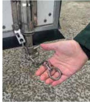
Abb. 5.1.25 Sicherheitskette unten an den Türen
