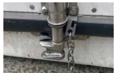
Εικόνα 5.1.23 Κλειδώστε τη ράβδο στην ασφαλή θέση στο κάτω μέρος.
