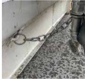
Σχήμα 5.1.26 Η αλυσίδα είναι στερεωμένη στο άγκιστρο και στις δύο πλευρές του εμπορευματοκιβωτίου.
