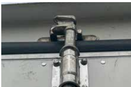
Figura 5.1.22 Bloquee la varilla en la posición superior.
