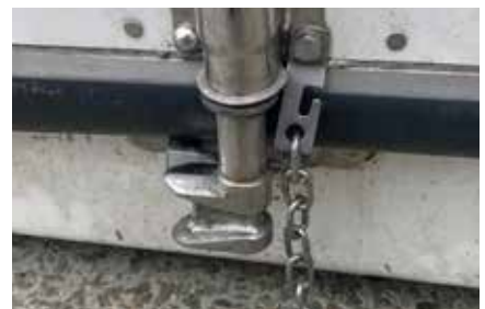
Figura 5.1.23 Bloquee la varilla en la posición inferior de seguridad.
