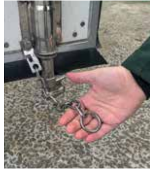
Figura 5.1.25 La cadena de seguridad se coloca en la parte inferior de las puertas
