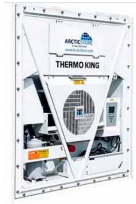
Lieu de travail - à l'arrière du conteneur Panneau IHM situé à droite
