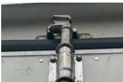
Figura 5.1.22 Bloccare l'asta in posizione di sicurezza superiore.
