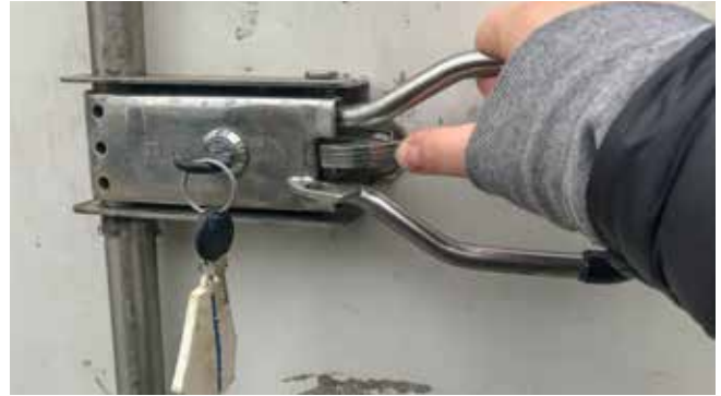
Figura 5.1.16 Premere il dispositivo di chiusura della serratura.
