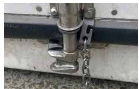
Figura 5.1.23 Bloccare l'asta in posizione inferiore di sicurezza.
