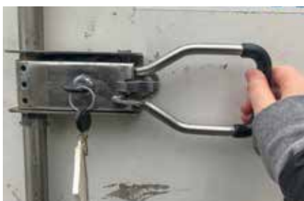
Figura 5.1.21 Il dispositivo di chiusura scatta.
