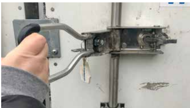
Obrázok 5.1.17 Potiahnite za kľučku dverí.
