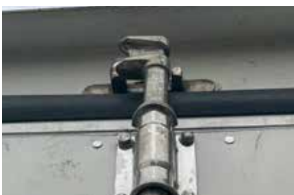
Obrázok 5.1.22 Zámkovú tyč zaistíte v hornej polohe.
