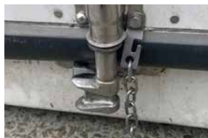
Obrázok 5.1.23 Zámkovú tyč zaistíte v spodnej polohe.
