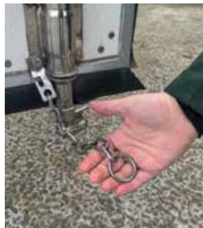
Obrázok 5.1.25 Bezpečnostný reťaz je umiestnený v spodnej časti dverí
