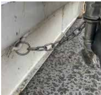
Obrázok 5.1.26 Reťaz je upevnená k háku na oboch stranách kontajnera.
