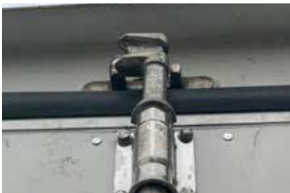
Şekil 5.1.22 Kilit çubuğunu güvenli konumda üstte tutun.
