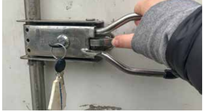
Şekil 5.1.16 Kilit kapatma cihazını bastırın.
