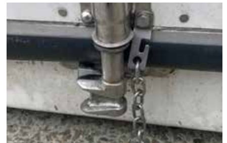
Şekil 5.1.23 Kilit çubuğunu alt kısımda sabit konumda kilitleyin.
