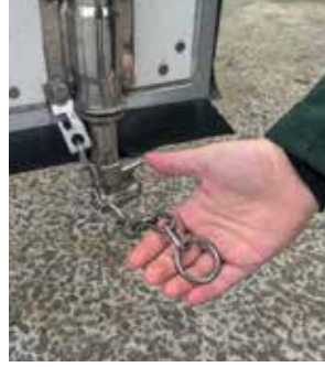
Şekil 5.1.25 Güvenlik zinciri kapıların alt kısmına yerleştirilir
